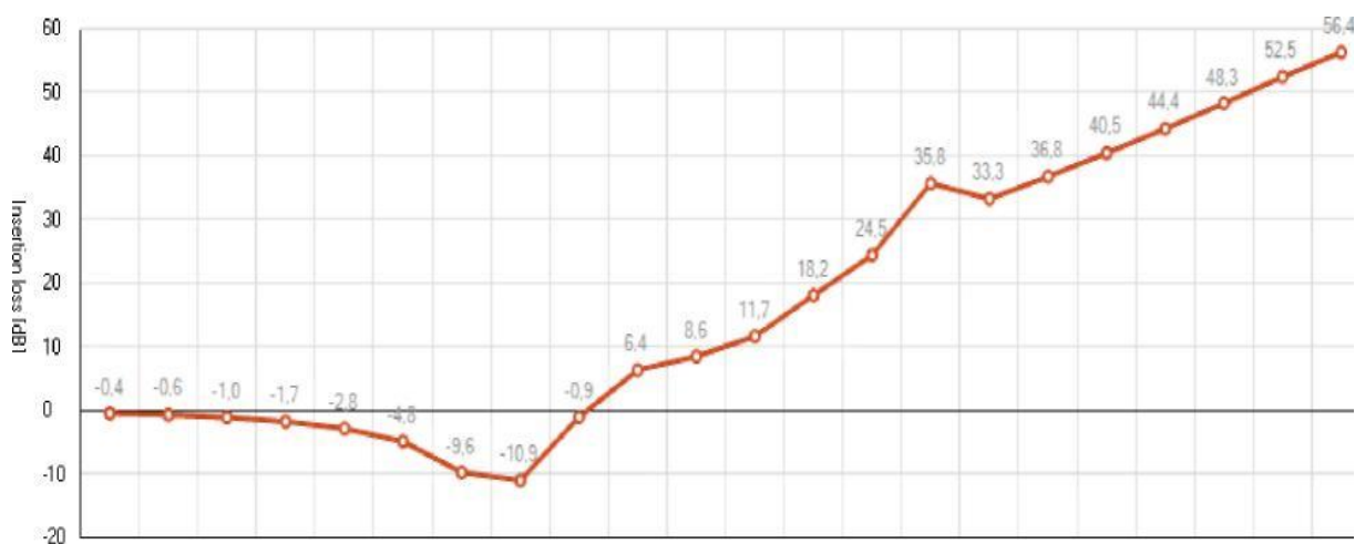
Rysunek 31 Wykres tłumienia dodanego - Modułowy system szyny w otulinie ERS-M oraz maty wibroizolacyjne STM RPU Blue 12 mm
